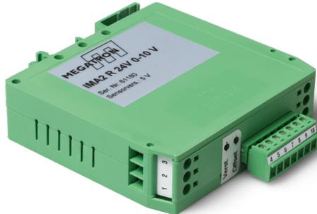
Der IMA2-R Messverstärker dient der Umsetzung der Ausgangssignale von potentiometrischen Sensoren in genormte Ausgangssignale. Der angeschlossene Sensor wird standardmäßig mit 5 V über den IMA2 gespeist (optional 10 V). Am Ausgang stehen wahlweise die wichtigsten genormten Analogsignale zur Verfügung (0..5 V, 0..10 V,  $\pm 5$  V,  $\pm 10$  V, 0..20 mA, 4..20 mA). Die gesamte Elektronik ist in einem Phoenix-Gehäuse (UEGM) zur Tragschienenmontage untergebracht.
