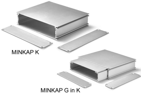
Das MINKAP K Aluminiumgehäuse für Leiterplatten von 107 mm Breite bietet 4 x 2 Führungsnuten zur Leiterplattenmontage mit 1,6 mm Leiterplattenstärke. Das Gehäuse besitzt eine Innenhöhe von 26,2 mm und wird in der Standardlänge 160 mm (kundenspezifische Längen bis max. 3.000 mm) mit oder ohne Abschlussplatten angeboten. Im Lieferumfang bei Plattenbestellung sind entsprechende Schrauben zur Befestigung enthalten. Die Aluminiumgehäuse stehen in Aluminium Natur eloxiert (optional blank) zur Wahl.
