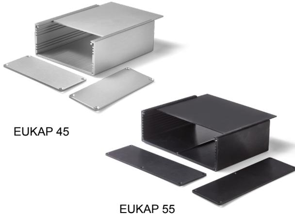
Die Serie EUKAP 45/55 besteht aus einem stabilen Aluminium-Profilgehäuse mit Einschubdeckel bzw. Boden. Serie EUKAP 45 ist für Europakarten mit 100 mm Breite von max. 1,6 mm Leiterplattenstärke und EUKAP 55 für Europakarten mit 164 mm Breite von max. 1,7 mm Leiterplattenstärke ausgelegt. Die Oberfläche ist Aluminium Natur oder schwarz eloxiert. Im Lieferumfang des Kits ist das U-Profil, der Deckel (bzw. Boden) und 2 Endplatten inkl. Schrauben enthalten.
